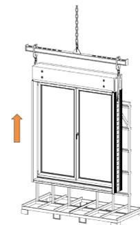
Anschlagen des WINDOWMENT®-Elements mit verstellbarer Traverse. Anschließend die Transportsicherung lösen.
